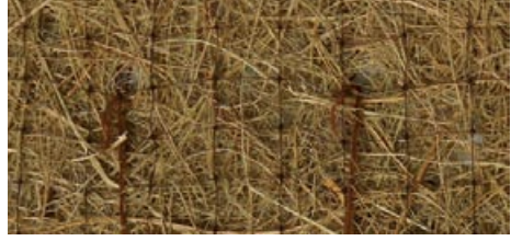
شكل 14. غطاء عضوي مُعد من الحلفاء ( Stipa tenacissima ) يُستعمل لمنع الانجراف عبر الجداول والخنادق
