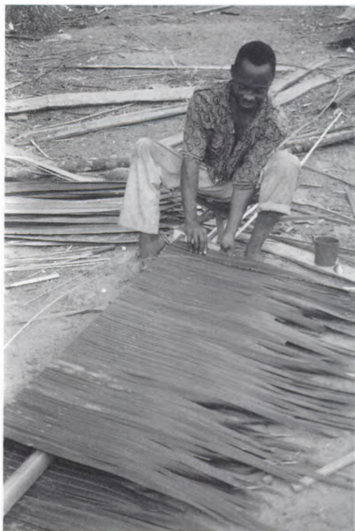
Fabrication des "tuiles" de Raphia
