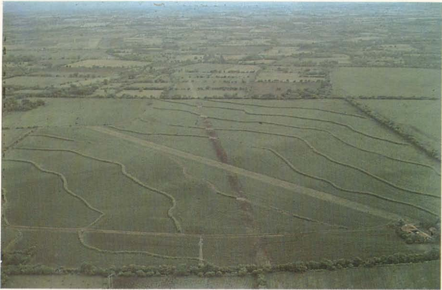
11.—Construcción de terrazas que han ayudado a disminuir la pérdida de suelos en las áreas agrícolas.
