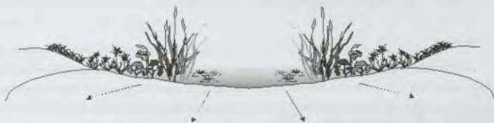
Fig. 1.9 (d) Groundwater recharge wetland (after Mitsch & Gosselink 1993)
