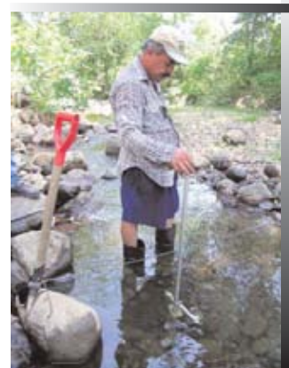
Medición de aforo del río Ixcanal, San Francisco Menéndez (Equipo campo SNET, 2005)
