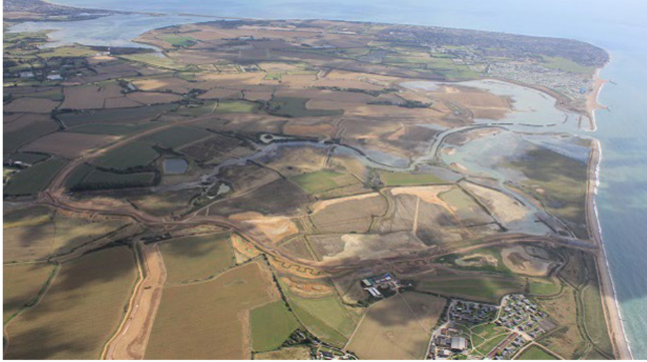
الشكل 9: صورة جوية لمشروع ميدميري (Medmerry). ذهب أصحاب المصلحة المحليون مع وكالة البيئة، لمشاهدة خرق بعرض 110م من ضفة الألواج الخشبية الحالية، مما يسمح بتدفق مياه المد والجزر لإنشاء 183 هكتاراً من منطقة موائل البحر الوطني الجديدة. © وكالة البيئة. تحتوي على معلومات قطاع عام مرخصة تحت ترخيص الحكومة المفتوحة الطبعة 3.0
