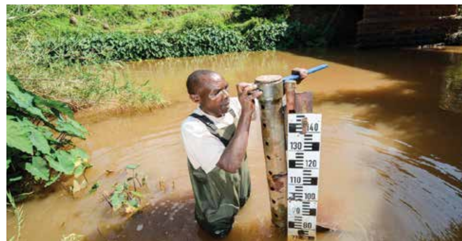
Hình 7 Cán bộ Cơ quan Quản lý Tài nguyên Nước Kenya (WRMA) đang lắp đặt các giá đỡ đồng hồ đo mực nước ở sông Tana © CIAT/Georgina Smith
